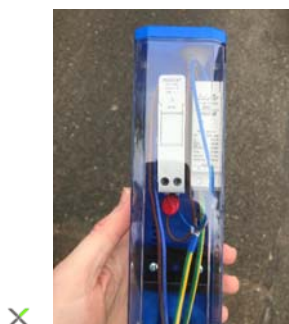
FIGURE 6 : BOITIER DE RACCORDEMENT IP2X AVEC PARAFoudre ET VARISTANCE
